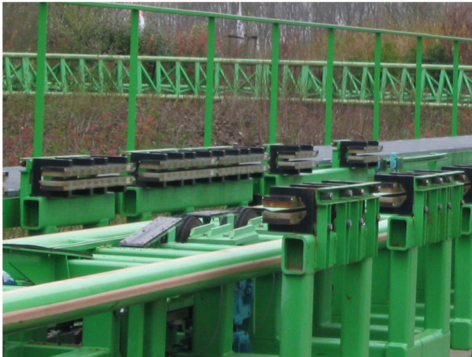
FIGURA 13.26 Las filas de imanes de tierras raras (que sobresalen horizontalmente) se utilizan para el frenado magnético en las montañas rusas (créditos: Stefan Scheer).
