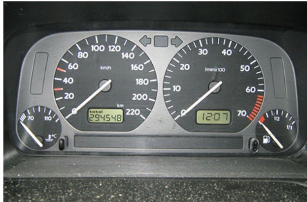
FIGURA 10.34 Los indicadores de combustible y temperatura (extremo derecho y extremo izquierdo, respectivamente) de este Volkswagen de 1996 son voltímetros que registran la salida de voltaje de las unidades "emisoras". Estas unidades son proporcionales a la cantidad de gasolina en el tanque y a la temperatura del motor (créditos: Christian Giersing).
