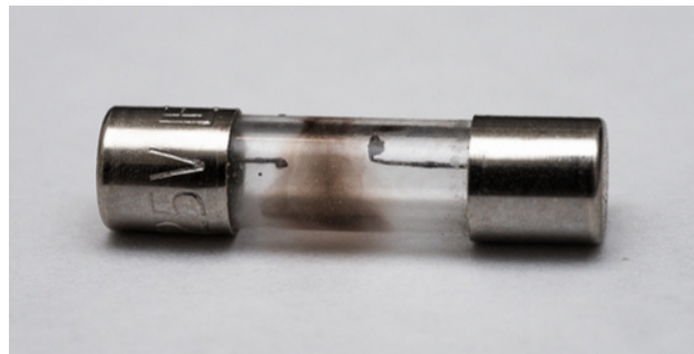
FIGURA 9.25 Un fusible consiste en un trozo de cable entre dos contactos. Cuando una corriente superior a la nominal pasa por el cable, este se funde, rompiendo la conexión. En la imagen se muestra un fusible "fundido" en el que el cable se rompió para proteger un circuito (créditos: modificación de la obra de "Shardayyy"/Flickr).
