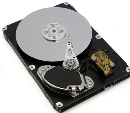
FIGURA 12.28 El interior de un disco duro. El disco plateado contiene la información, mientras que el fino lápiz óptico situado en la parte superior del disco lee y escribe información en este.
