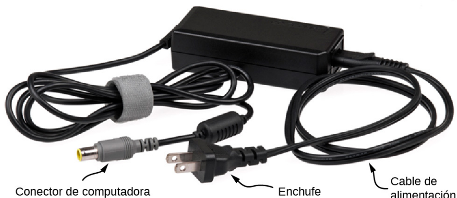
FIGURA 5.9 Este adaptador de corriente utiliza cables y conectores de metal para conducir la electricidad desde la toma de corriente hasta la computadora portátil. Los alambres conductores permiten que los electrones se muevan libremente a través de los cables, que están protegidos por goma y plástico. Estos materiales actúan como aislantes que no permiten que la carga eléctrica salga al exterior (créditos: modificación del trabajo de "Evan-Amos"/Wikimedia Commons).
