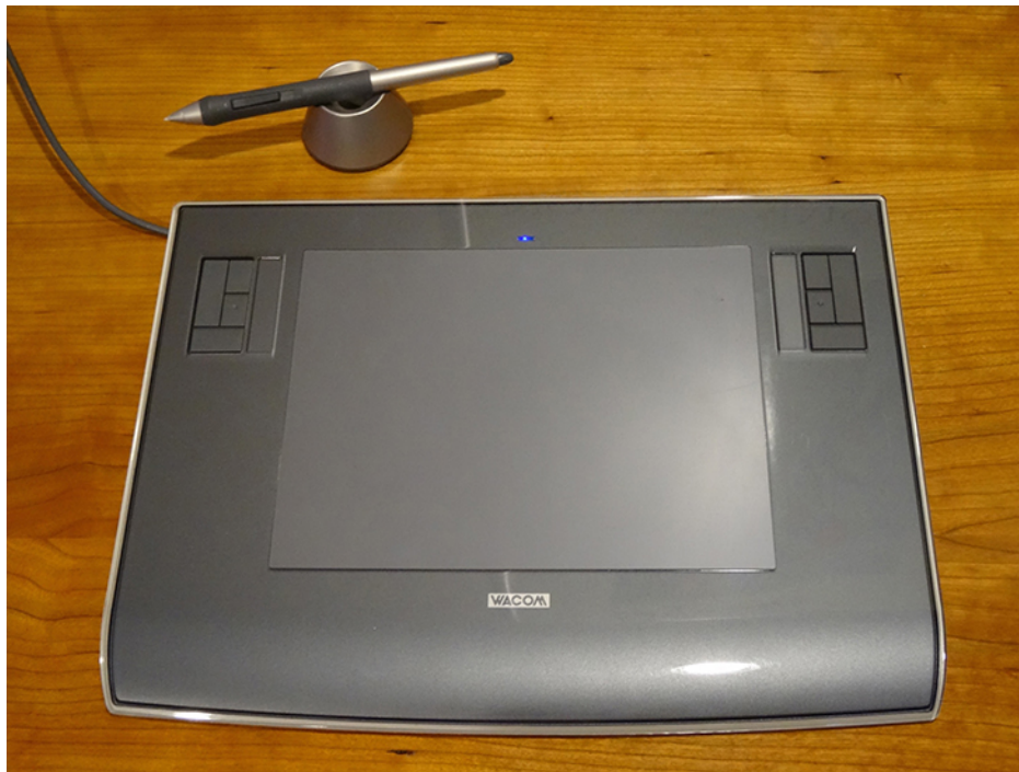
FIGURA 13.34 Una tableta con un bolígrafo especialmente diseñado para escribir es otra aplicación de la inducción magnética (créditos: Jane Whitney).
