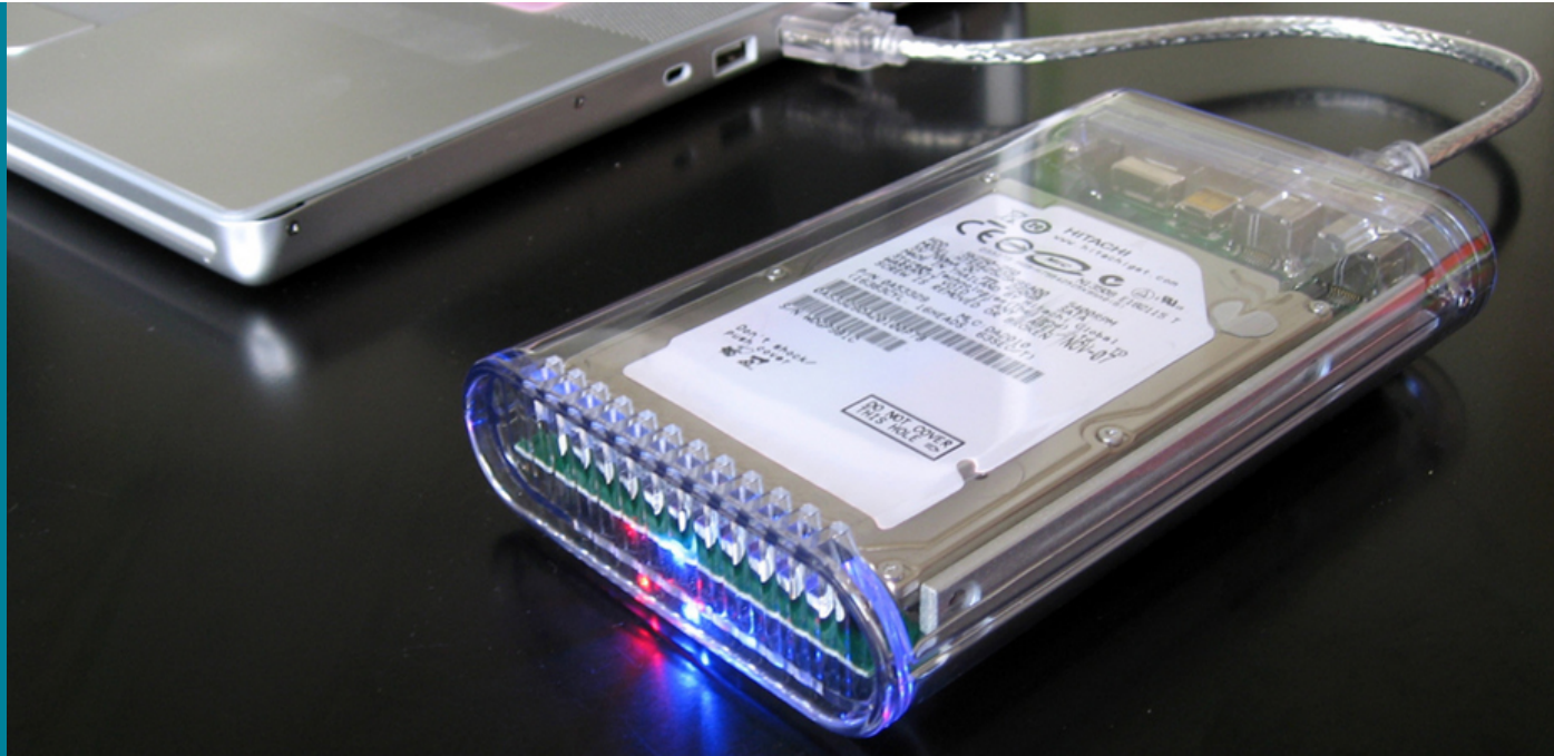
Figura 12.1 Un disco duro externo conectado a una computadora funciona codificando magnéticamente la información que se puede almacenar o recuperar rápidamente. Una idea clave en el desarrollo de dispositivos digitales es la capacidad de producir y utilizar campos magnéticos de esta manera (créditos: modificación de la obra de "Miss Karen"/Flickr).
