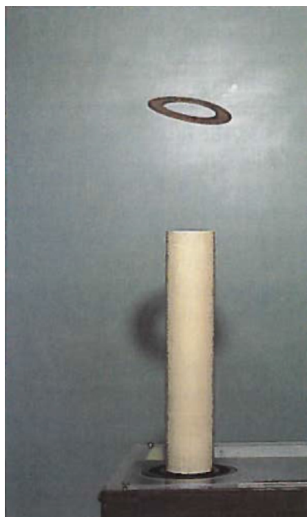
FIGURA 13.10 El anillo que salta. Cuando se enciende una corriente en el solenoide vertical, se induce una corriente en el anillo de metal. El campo perdido producido por el solenoide hace que el anillo salte.
