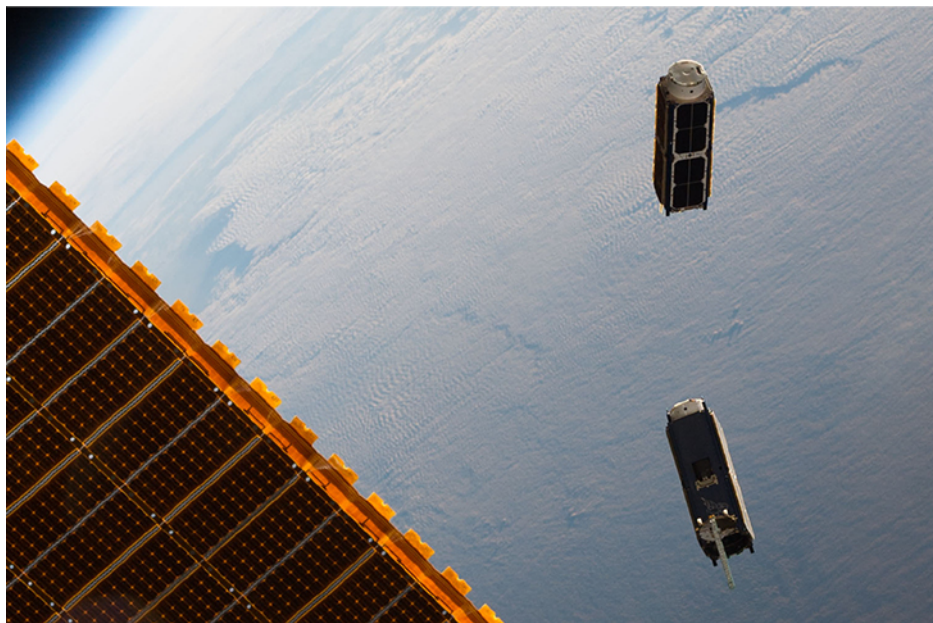
FIGURA 16.16 Dos pequeños satélites CubeSat desplegados desde la Estación Espacial Internacional en mayo de 2016. Las velas solares se abren cuando los CubeSats se alejan lo suficiente de la estación (créditos: modificación de un trabajo de la NASA).
